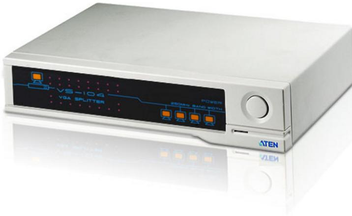
VS104 视频共享器能将所接收的视频信号，通过复制成4组250MHz的信号输出，并可通过影像增益调节钮来增强信号，其传输距离可达65M。
