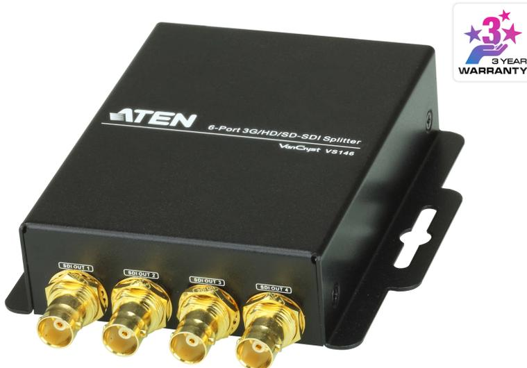
VS146 6端口3G/HD/SD-SDI视频分配器可接收1组SDI视频输入，并实时复制信号至6组SDI屏幕，提供自动线缆均衡，传送SDI距离远达300m。此外，VS146支持的SDI信号重整可在占口级联时传输更远的距离。VS146适用于监控系统、演播室、数字影院或任何影音应用环境，允许您从摄像机或其它配有3G/HD/SD-SDI输出的设备传送信号至6组兼容SDI的显示设备或视频处理器上。
