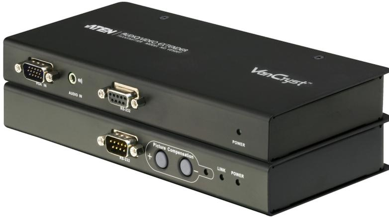
VE500 Cat 5影音信号延长器是专为搭配ATEN [VM0808T/VM1616T](#) Cat 5矩阵式影音切换器整合至架构中所设计，通过ATEN独有的抗色偏 (Deskew)技术，VE500可让用户延长影音信号来源与显示屏幕的距离，在传输距离达150m时，视频分辨率可达1600x1200(VE500R)，传输距离达300m时，视频分辨率可达1280x1024 (VE500RQ)。
