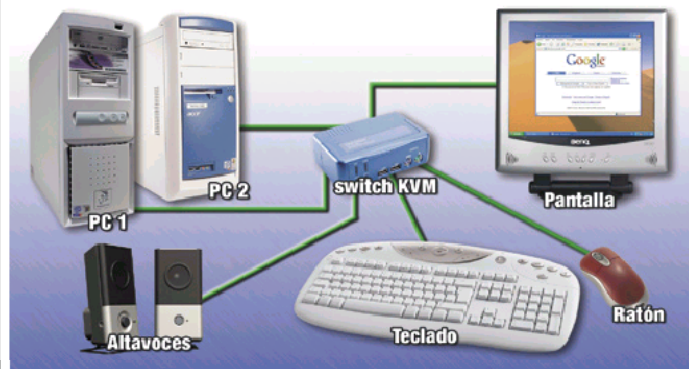
Gracias a un switch KVM es posible compatir un único monitor, teclado y ratón, o incluso otros periféricos como los altavoces, entre varios ordenadores.
