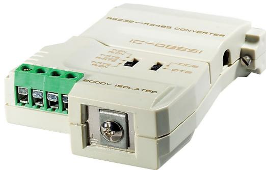
Der IC485SI ist ein 2-Weg-Wandler zur Umwandlung von RS-232 Signalen in und von RS-422/RS-485 Signalen in Langstrecken Anwendungen bis zu 1200 m (4000 ft.). Er verfügt über eine Erdung für verbesserte Signal- und Stromisolation.
