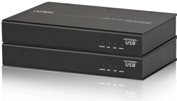
El extensor KVM DVI USB 2.0 CE610 es un extensor DVI y USB que admite ExtremeUSB® y la tecnología HDBaseT. El Extensor KVM DVI USB 2.0 CE610 puede extender las señales DVI y USB 2.0 hasta 300 pies (100 m) desde la fuente utilizando un único cable de Cat 5e/6.
