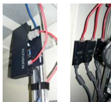
シリアルデバイスとの接続に使用しているKA9140(左)と、PS/2インターフェースのコンピューターとの接続に使用しているKA9120(右)
