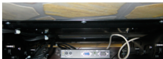
ディスプレイの裏側にセットアップされたVE200R (壁面とディスプレイの間を上方から撮影)
