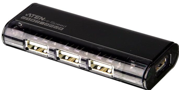
Le concentrateur UH284 appartient à la série de concentrateurs USB 2.0 à 4 ports compacts et hautement fonctionnels de la marque ATEN, pour les ordinateurs de bureau et les ordinateurs portables. Il présente un support aimanté intégré et peut être placé quasiment n'importe où. Le concentrateur UH284 offre 4 ports USB 2.0 supplémentaires aux systèmes USB existants, dont un port facile d'accès idéal pour la connexion d'un disque à mémoire flash.
