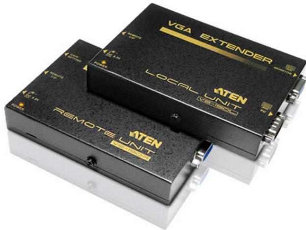
L'extender video VE150 è costituito da un'unità locale trasmittente e da un'unità remota ricevente connesse tra loro da cavi Cat5e standard. La distanza massima tra le unità è di 150m. Si tratta di una soluzione ideale per fabbriche e cantieri o altri luoghi dove lo schermo può essere esposto a rischi mentre si desidera mantenere il sistema al sicuro.
