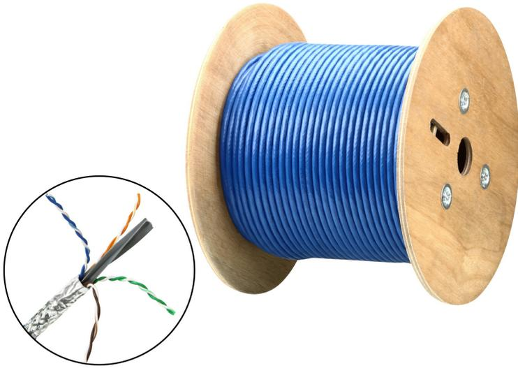
2L-2910は、HDBaseTアライアンス推奨カテゴリ6 SF/UTPケーブルです。4K解像度での映像信号やアナログ/デジタル信号、オーディオ等の信号伝送を最適化するために開発されました。2L-2910は、最大掃引周波数400MHz対応で、HDBaseTアライアンスが定めた仕様に準拠しています。
