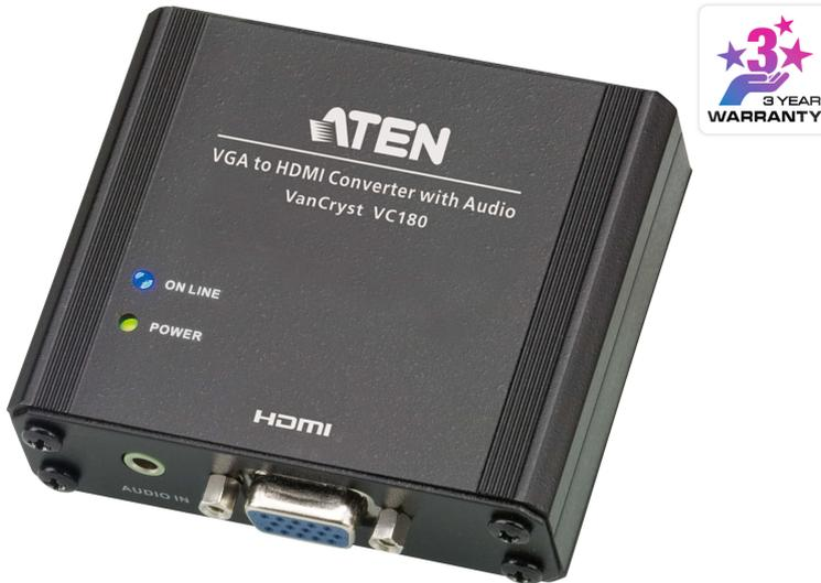
VC180は、アナログVGA信号とオーディオ信号をHDMI信号に変換するコンバーターです。機器の映像と音声を入力ポートに接続すると、これらの信号をデジタル変換してHDMIケーブル1本で出力します。本製品は、VGAポートからのバスパワーに対応していますが、VGAポートからの給電が十分でない場合は、電源アダプターから給電することも可能です。ソフトウェアのインストールも不要で、コンパクトな本体はセットアップしやすいのが特長です。
