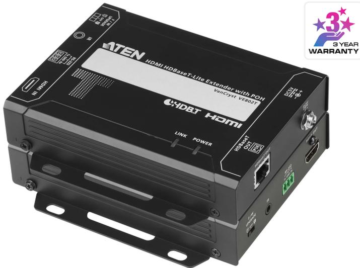
VE802は、Cat6aケーブル1本で、電源と1系統のHDMI信号を解像度4K<sup>\*1</sup>の場合は最大40m、解像度1080pでは最大70m延長できるHDMIツイストペアケーブルエクステンダーです。
