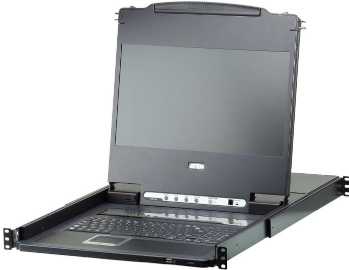
El CL6708MW aporta versatilidad adicional a la gama de switches KVM con LCD de ATEN gracias a su compatibilidad nativa con DVI. Se basa en la prestigiosa estructura de switches KVM compactos de ATEN, en los que se integran un panel LCD, teclado completo y panel táctil en una carcasa optimizada de 1U. El CL6708MW es un switch KVM con LCD altamente escalable que permite controlar hasta 64 ordenadores colocando en cascada 8 switches KVM [CS1768](#) de 8 puertos adicionales.
