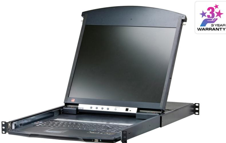
El switch KVM de dos módulos retráctiles con pantalla LCD KL1508Ai es una unidad de control que da acceso a hasta 8 computadoras desde una única consola KVM (teclado, monitor y mouse). Consiste en un monitor LCD, teclado y panel táctil integrados en una unidad retráctil que se puede instalar en una ranura 1U del rack.
