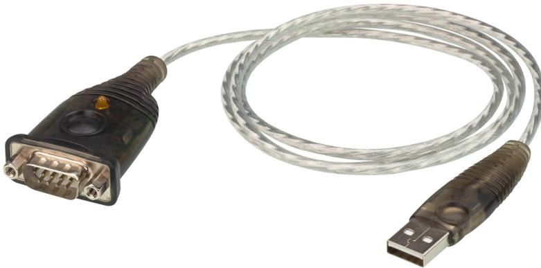
El convertor de puerto serie [UC232A](#) USB a RS232 es el accesorio ideal para ordenadores portátiles y de sobremesa que no tienen un puerto serie COM o DB9. Es compatible con sistemas PC y Mac, con velocidades en baudios de hasta 921.6 Kbps para una transmisión rápida. Ofrece una solución de conectividad cómoda para sistemas de automatización industrial, instrumentos científicos, sistemas de punto de venta y otras aplicaciones y otras aplicaciones industriales especializadas y de consumo.
