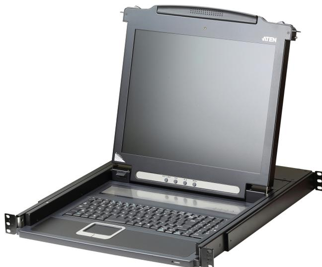
CL1000 é uma consola LCD KVM que funciona como primeira linha para os tradicionais switches KVM. CL1000 possui um painel LCD com retroiluminação LED, de 17" ou 19", teclado completo, e painel tátil numa Slideaway™ 1U, de montagem em prateleira.
