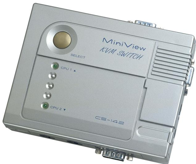
O CS-142 é um KVM Switch com PS/2 embutido. Pode controlar 2 servidores através de um único console e permite que usuários alternem entre computadores através de botões do lado de cima do switch ou configuração de teclas de atalho no teclado do console. É a solução mais simples e conveniente para gerenciamento de vários computadores.
