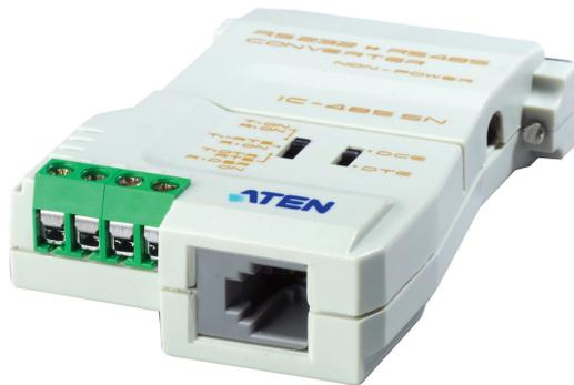
Der IC485SN ist ein 2-Weg-Wandler zur Umwandlung von RS-232 Signalen in und von RS-422/RS-485 Signalen in Langstrecken Anwendungen bis zu 1200 m (4000 ft.) – ohne eine externe Stromversorgung zu benötigen.
