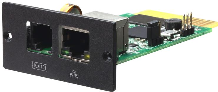
SP100 (SNMP-Karte) von ATEN ist USV-Überwachungsequipment. Ermöglicht, die USV über einen RJ-45-Anschluss direkt mit dem Ethernet-Netzwerk zu verbinden, ohne RS-232-Ports am Computer zu verwenden und individuelle USV-Managementsoftware auf dem Netzwerkserver zu laden. Der Benutzer kann die USV remote steuern und den aktuellen USV-Status von jedem beliebigen Offsite-Standort aus überwachen. SP100 kann den Status einer USV kommunizieren und Befehle an sie absetzen.
