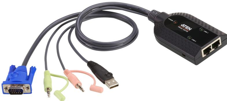
Das USB-KVM-Adapterkabel KA7178 verbindet Ihren KVM-Switch mit den Grafik-, USB-Tastatur- und –Maus- sowie Audioanschlussbuchsen des Zielcomputers. Es unterstützt nicht nur virtuelle Datenträger, sondern besitzt zwei Kat. 5e/6-Anschlüsse, über die Sie einen Computer mit bis zu zwei ALTUSEN KVM-Matrix-Switches verbinden können. Dadurch können die Konsolen verschiedener Switches auf dieselben Computer zugreifen.
