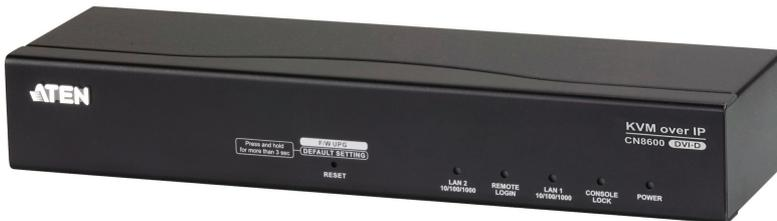
Der CN8600 ist ein KVM over IP für DVI mit einem exzellenten Preis/Leistungs-Verhältnis, über den der Fernzugriff auf Bild- und Tonsignale sowie virtuelle Datenträger von einem PC oder einer Workstation aus möglich ist. Der CN8600 bietet Over-IP-Zugriff durch den Anschluss eines kompatiblen DVI-KVM-Switches von ATEN bzw. einer LCD-Konsole, wie z.B. einen [CS1768](#) (USB-KVM-Switch mit 8 Ports für DVI-Grafik) oder eine [CL6700](#) (DVI-LCD-Konsole).
