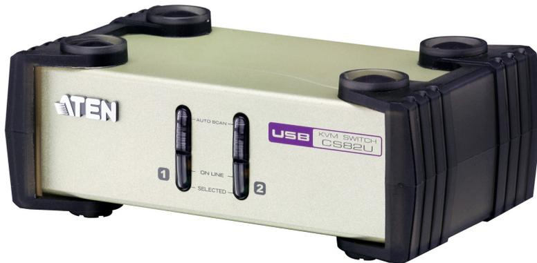
Der PS/2-USB-KVM-Switch CS82U ist ein Gerät zur Schreibtischinstallation, das es ermöglicht, zwei Computer von einer einzigen KVM-Konsole (PS/2- oder USB-Tastatur und -Maus sowie VGA-Monitor) zu steuern. Zusätzlich unterstützt der CS82U die neue Video DynaSync™-Technologie von ATEN, die Anzeige Probleme beim Einschalten von Geräten verhindert und die Auflösung optimiert.
