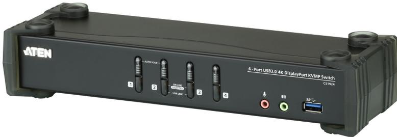
Der ATEN CS1924 4-Port USB 3.0 4K DisplayPort KVMP™ Switch bietet die neuesten Innovationen in der Desktop KVM Switching Technologie für den zunehmenden Bedarf an höherer Videoqualität und Übertragungsgeschwindigkeiten auf modernen Computern. Der ATEN CS1924 bietet eine unvergleichliche Leistung bei der Anzeige von 4K Auflösung, USB 3.1 Gen 1 Hub der nächsten Generation mit Datenübertragungsraten von SuperSpeed 5 Gbps und verbesserter benutzerfreundlicher Bedienung.
