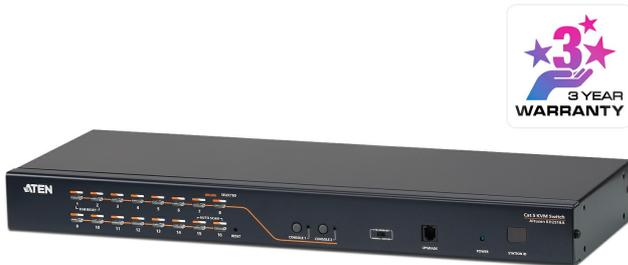
Der KVM-Switch KH2516A ist eine Steuereinheit, die es IT-Administratoren ermöglicht, mehrere Computer von zwei PS/2- oder USB-Konsolen (zwei Bus) aus zu steuern. Sysops können an bis zu zwei Konsolen unabhängig und gleichzeitig bis zu 16 Computer steuern. Durch Reihenschaltung von maximal 31 weiteren Switches können sogar von den ursprünglichen KVM-Konsolen bis zu 512 Computer verwaltet werden.
