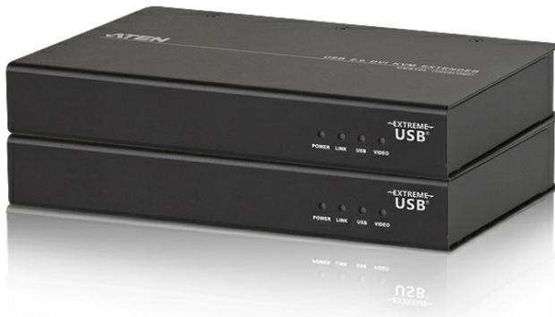
Der USB 2.0-DVI-KVM-Extender CE610 ist ein DVI- und USB-Extender, der ExtremeUSB®- und HDBaseT-Technologie unterstützt. Der USB 2.0-DVI-KVM-Extender CE610 kann DVI- und USB 2.0-Signale über ein einzelnes Cat-5e/6-Kabel bis 100 m von der Quelle verstärken.
