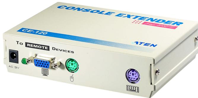
Der CE120 ist eine KVM-Verlängerung für PS/2-Konsolen. Über sie können Benutzer eine Verbindung zu entfernten Serversystemen herstellen und auf diese zugreifen. Hierzu sind lediglich ein paar Kabelverbindungen nötig - zusätzliche Werkzeuge oder Software sind nicht erforderlich.
