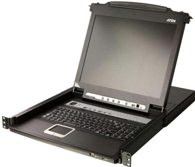
Die CL5716 Slideaway – LCD KVM Switch Serie ist eine Steuerung, die den Zugriff auf mehrere Computer über eine einzige PS/2 oder USB KVM (Tastatur, Video und Maus) Konsole ermöglicht. Ein einzelner CL5716 kann bis zu 8 oder 16 Computer steuern. Bis zu 31 zusätzliche KVM-Switches können in Daisy-Chain mit dem CL5716 verbunden werden, so dass bis zu 512 Computer von einer einzigen KVM-Konsole aus gesteuert werden können.
