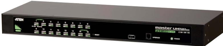
Der KVM-Switch CS1316 erlaubt die Fernsteuerung und Überwachung von bis zu 256 Computern von einer einzigen Konsole (Tastatur, Bildschirm, Maus) aus. Es können 16 zusätzliche Switches kaskadiert werden, was die Gesamtanzahl verbundener Computer, die von einer einzigen KVM-Konsole gesteuert werden können, auf 256 erhöht. Der Switch unterstützt Konsolen und Computer mit sowohl PS/2- als auch USB-Anschlüssen.
