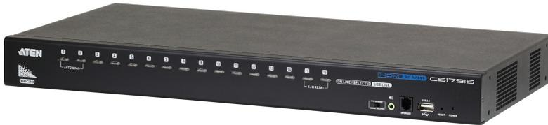
Der CS17916 USB-HDMI-KVM-Switch mit 16 Anschlüssen ist ein Mehrzweckgerät, das den Zugriff und die Steuerung von bis zu 16 HDMI-Computern über eine einzige USB-Tastatur, USB-Maus und Monitorkonsole ermöglicht. Der CS17916 kann bis zu zwei Ebenen kaskadiert werden – bis zu 256 Computer – alles von einer einzigen Konsole aus.
