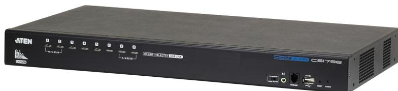
Der CS1798 8-Port USB HDMI KVM-Switch ist ein Mehrzweckgerät, das den Zugriff und die Steuerung von bis zu 8 HDMI-Computern über eine einzige USB-Tastatur, USB-Maus und Monitorkonsole ermöglicht. Der CS1798 kann auf bis zu drei Ebenen kaskadiert werden – zur Steuerung von bis zu 512 Computern - alles von einer einzigen Konsole aus.
