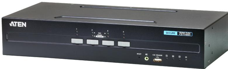
Der ATEN PSS PP v3.0 Secure KVM Switch (CS1144H) wurde speziell für die hohen Sicherheitsanforderungen von Verteidigungs- und Aufklärungsinstallationen entwickelt. Der ATEN PSS PP v3.0 Secure KVM Switch (CS1144H) entspricht dem von der National Information Assurance Partnership (NIAP) zertifizierten Standard PSS PP v3.0 (Protection Profile for Peripheral Sharing Switch, Version 3.0).
