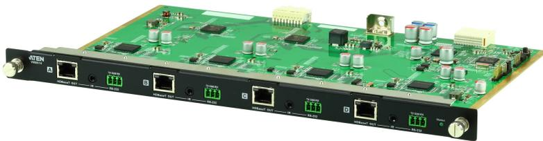
Die VM8514 4-Port HDBaseT Ausgabekarte bietet eine einfache Möglichkeit, 4 HDBaseT Sender an 4 an 4 HDBaseT Empfänger weiterzuleiten, und bietet in Kombination mit den ATEN Modular Matrix Switches die Möglichkeit, bis zu 32 Eingangs- und 32 Ausgangs-HDBaseT Verbindungen weiterzuleiten.
