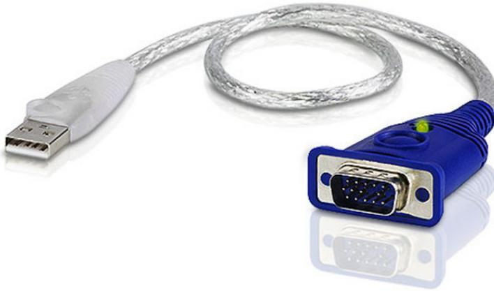
Der VGA-EDID-Emulator 2A-130G wurde für Installationen mit ATEN-KVM-Verlängerungen oder –Grafik-Splittern entwickelt, bei denen kein lokaler Monitor am Standort des Computers bzw. der Signalquelle vorhanden ist. Dabei emuliert und speichert der 2A-130G die Standard-EDID-Einstellungen (Extended Display Identification Information) von ATEN in einem nicht-flüchtigen Speicher. So kann der Computer bzw. kann die Signalquelle einen Bildschirm "sehen", obwohl gar keiner angeschlossen ist.
