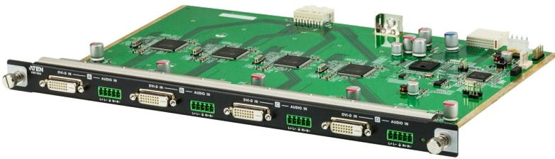
Die VM7604 4-Port DVI Eingangskarte bietet eine einfache Möglichkeit zum Durchleiten von 4 Audio/Videoquellen an 4 Anzeigen, wenn sie in Kombination mit ATENs Modular Matrix Switch verwendet wird.
