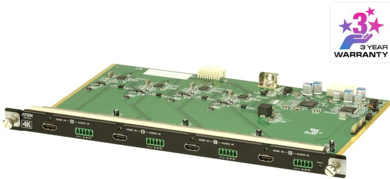
Die VM7814 ist eine 4K HDMI-Eingangskarte, die mit einem ATEN Modular Matrix Switch arbeitet und eine einfache Möglichkeit bietet, 4 HDMI-Quellen auf 4 Displays zu routen. Zusätzlich zur HDMI-Schnittstelle, die digitale A/V-Signale überträgt, verfügt die VM7814 über 4 Stereo-Audioeingänge, die eine Stereo-Audioeinbettung ermöglichen.
