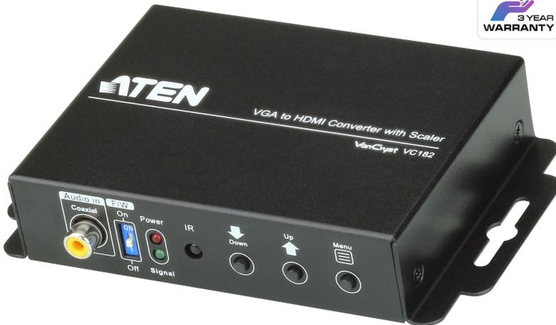
Mit dem VGA-auf-HDMI-Konverter mit Skalierfunktion VC182 lassen sich VGA-Eingangssignale schnell und einfach in digitale HDMI-Signale umwandeln. Der VC182 ist mit einem Hochleistungs-Skalierer ausgestattet, der jedes Eingangssignal in die Bildauflösung umwandelt, mit der die beste Qualität erreicht wird.
