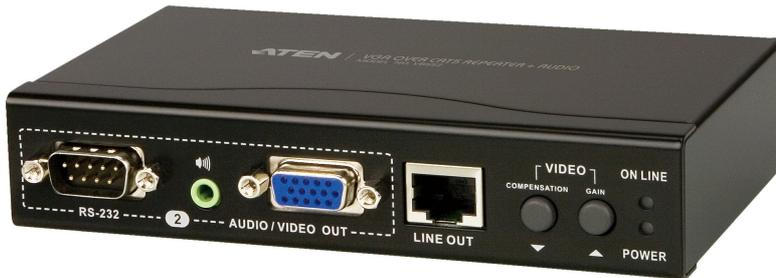
Der VGA Over Kat. 5-Repeater mit Tonübertragung VB552 ist eine A/V-Signalverlängerung, die zu den Kat. 5-A/V-Splittern von ATEN kompatibel ist. Der VB552 vergrößert den Übertragungsweg für A/V-Signale auf bis zu 150 m über herkömmliche Kat. 5e-Kabel (oder besser). Bei Verwendung eines weiteren Repeaters besteht die Möglichkeit, die A/V-Signale über bis zu 450 m zu übertragen.
