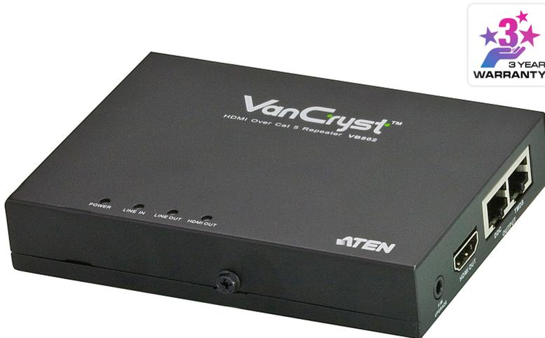
Der HDMI Over Kat. 5-Repeater VB802 ist eine HDMI-Signalverlängerung, die zu den HDMI Over Kat. 5-Splitttern bzw. Verlängerungen von ATEN kompatibel ist. Der VB802 vergrößert den Übertragungsweg auf bis zu 60 m über herkömmliche Kat. 5e-Kabel.
