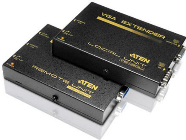
Die Grafikverlängerung VE150 besteht aus einer lokalen Sendeeinheit sowie einer Empfangseinheit für die Gegenstelle, die über ein herkömmliches Kat. 5e-Kabel verbunden werden. Die Entfernung zwischen beiden Geräten kann bis zu 150m betragen. Sie eignet sich insbesondere für Fabriken und Baustellen sowie Umgebungen, wo das Anzeigegerät an einem sensiblen Ort aufgestellt ist, Sie jedoch die Systemeinheit an einem sicheren Platz aufstellen möchten.
