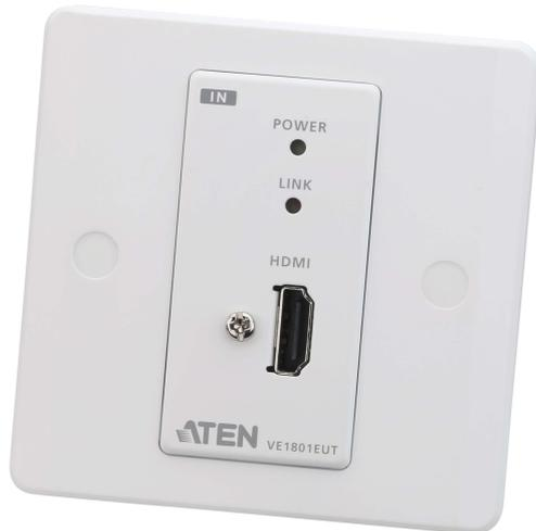
Der ATEN VE1801EUT ist ein Transmitter, der entwickelt wurde, um 4K-Signale bis zu 40 m über ein einziges Cat 5e/6/6a oder ATEN [2L-2910](#) Cat 6 Kabel zuverlässig zu senden. Mit dem EU-Wandplattendesign kann der VE1801EUT bequem in einem Einfach-Anschlusskasten montiert werden. Für die Übertragung von HDMI-Signalen unterstützt er 3D-, Deep Color- und eingebettete verlustfreie HD-Audioformate.
