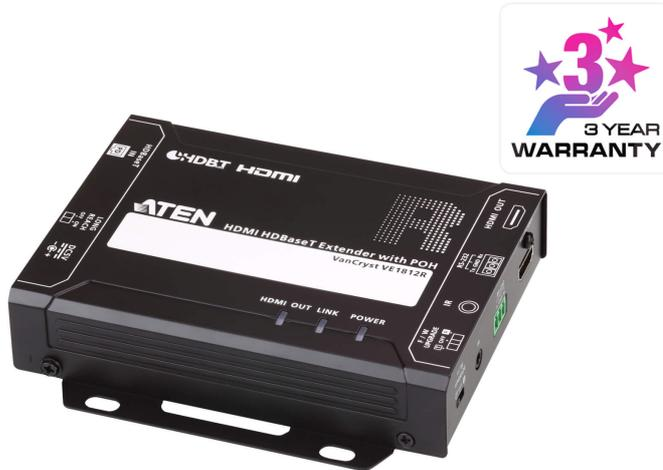
Der [VE1812T](#) verfügt über Power over HDBaseT (PoH), was Strom von Tx zu Rx über Cat 5e/6a Kabel ohne zusätzliche Stromversorgung sendet. Der [VE1812T](#) unterstützt RS-232- und IR-Signalübergabe, so dass Sie das HDMI-Quellgerät vom Empfängergerät (VE1812R) aus steuern können und gleichzeitig auf das HDMI-Displaygerät vom Sendergerät ([VE1812T](#)) aus zugreifen können. Die IR-Signale können auch in beide Richtungen erweitert werden.
