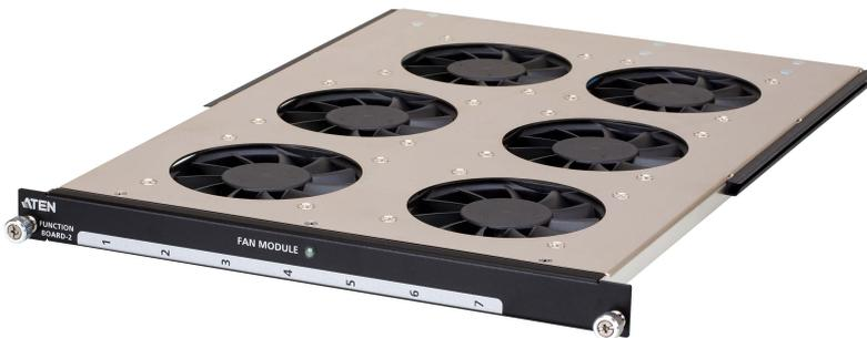
Der VW-FAN556 kann in den modularen Videowandprozessor ATEN [VW3620](#) 36 x 20 eingebaut werden, um die Luftzirkulation zu verbessern und das Risiko von Systemausfällen durch Überhitzung zu vermeiden. Das Lüftermodul ist im laufenden Betrieb austauschbar und kann ganz einfach ohne Abschalten des Systems ausgetauscht werden, sodass ein 24/7-Betrieb in allen wichtigen Videowandanwendungen gewährleistet ist.
