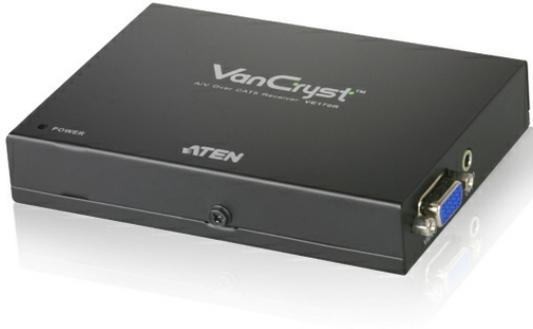
El receptor de A/V mediante Cat 5 VE170R, conectado con un transmisor\*, aumenta las señales hasta 300 metros desde la fuente mediante un cable Cat 5e. Es una solución rentable y eficiente para el envío y recepción de contenidos de audio y vídeo de alta calidad.
