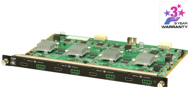
La VM8814 es una tarjeta de salida HDMI 4K que se combina con un conmutador de matriz modular de ATEN para facilitar el enrutamiento de 4 fuentes HDMI hasta 4 pantallas. Además de la interfaz HDMI para señales de audio/vídeo digitales, la VM8814 tiene 4 puertos de salida de audio estéreo que permiten la extracción de audio HDMI.
