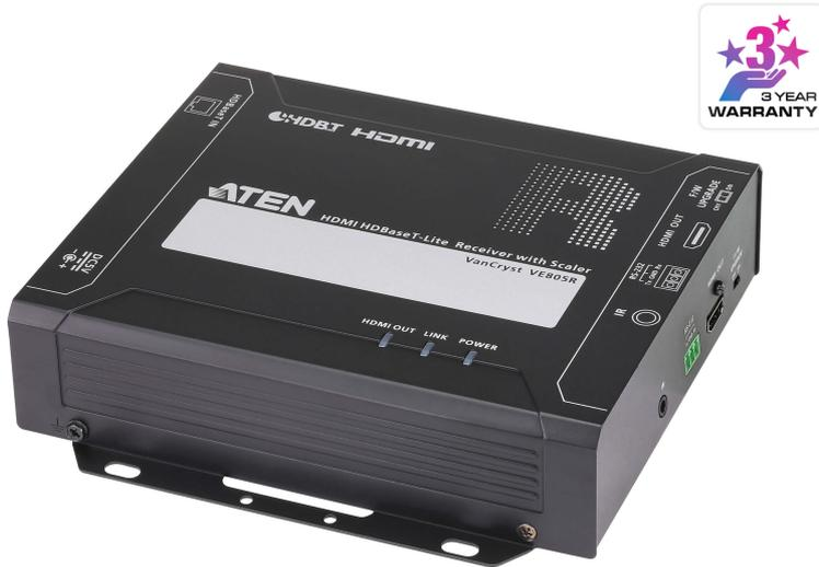
El receptor VE805R HDMI HDBaseT-Lite con escalador puede combinarse con los productos ATEN HDMI HDBaseT para ampliar un monitor HDMI hasta 60 m desde el dispositivo fuente HDMI mediante un único cable Cat 5e/6 o hasta 70 m a través de un cable Cat 6a.
