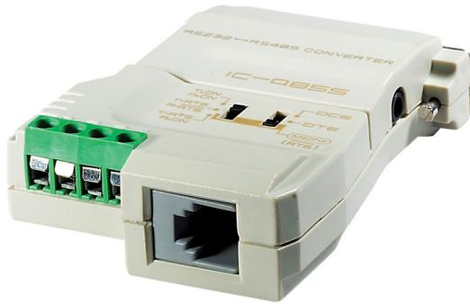
El IC485S es un convertidor bidireccional con el que convertir señales RS-232 a RS-422/RS-485 en aplicaciones a larga distancia, de hasta 1200 m (4000 ft). Admite la conexión de hasta 32 hubs, e incorpora funciones de supervisión para confirmar los datos que se transfieren entre los dispositivos.
