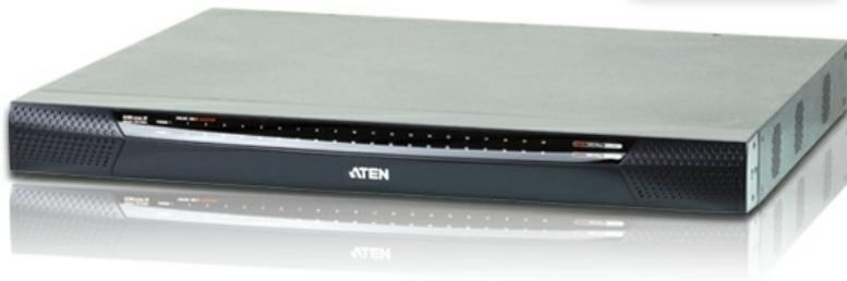
La cuarta generación de conmutadores KVM a través de IP de ATEN supera las expectativas. Los modelos KN2140VA ofrecen una excelente calidad de vídeo con resoluciones hasta 1920 x 1200, estándar de seguridad FIPS 140-2 nivel 1 y transmisión de contenido virtual multimedia al doble de la velocidad normal.
