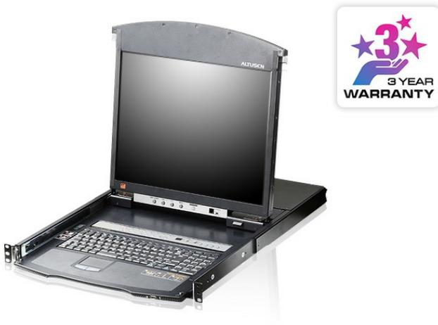
El switch KVM de dos módulos retráctiles con pantalla LCD KL1516Ai es una unidad de control que da acceso a hasta 16 computadoras desde una única consola KVM (teclado, monitor y mouse). Consiste en un monitor LCD, teclado y panel táctil integrados en una unidad retráctil que se puede instalar en una ranura 1U del rack.
