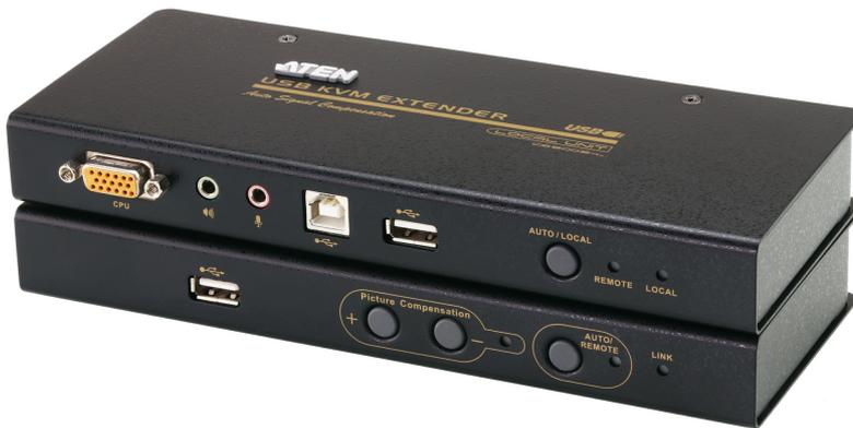
El KVM USB Extender CE800B con audio permite acceso a computadores desde una consola remota con altavoces y micrófono. Es perfecto para fábricas o sitios de construcción o cualquier tipo de instalación donde la consola necesita estar en una posición conveniente pero el computador debe permanecer en un área segura, lejos del polvo, etc.
